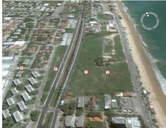
Figura 3. Representação esquemática da distribuição das zonas de exposição do aparato da vela úmida (earth.google.com [10]).
