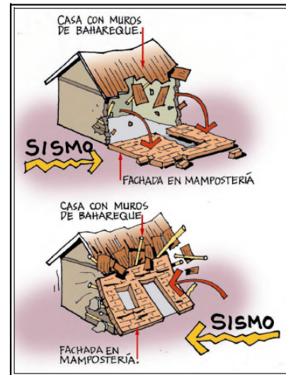
Figura 4.- Existencia de cambios de rigidez importantes en la estructura.
