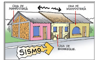
Fig. 5.-Cambios de rigidez elevados pueden implicar contactos durante la acción sísmica.
