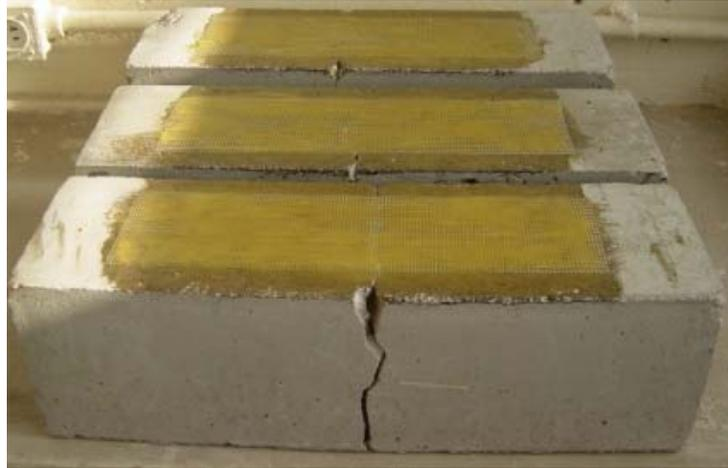
Figura 4. Especto final de la viga reparada con material compuesto. En términos de porcentaje de refuerzo, es equivalente al 0.2%.
