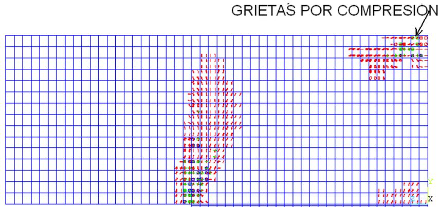
Figura 9. Patrón de agrietamiento para una viga reparada con longitud de anclaje de 14 cm.
