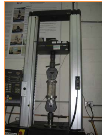
Figura 4.- Maquina universal para realizar pruebas de tensión, Modelo instron 4469
