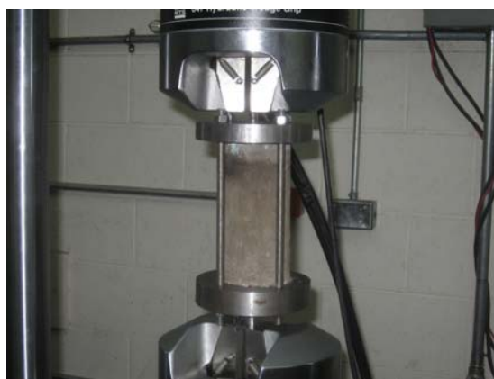
Figura 4.- Maquina universal realizando las pruebas de jalón a los especímenes
