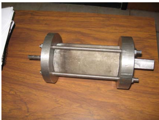
Figura 3.- Dispositivo para realizar las pruebas de jalón en la maquina universal.
