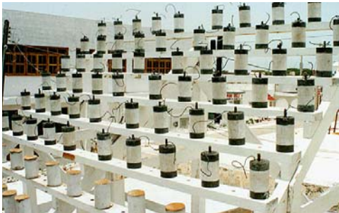
Fig. 1.- Probetas en exposición a ambiente marino.
