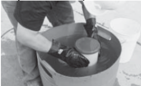
Figura 2. Curado de cilindros de concreto
