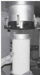
Figura 3. Ensayo de compresión del concreto
