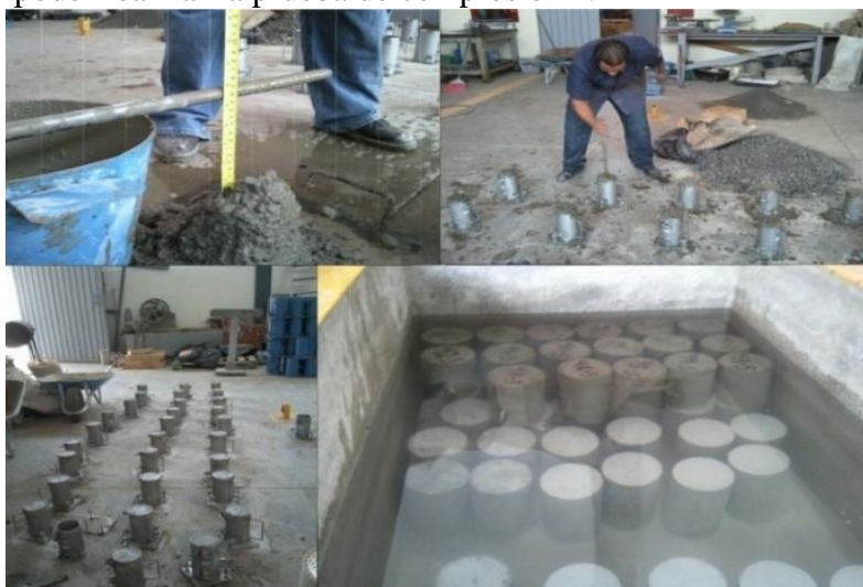
FIGURA 1. Elaboración y curado de los especímenes cilíndricos.
