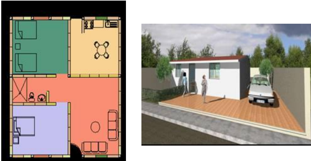
Figura 4. Modelo de vivienda de 90 m 2 de crecimiento progresivo
