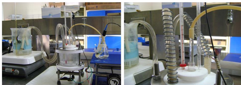
Figura 1. Arreglo experimental utilizado en las pruebas electroquímicas a diferentes temperaturas.
