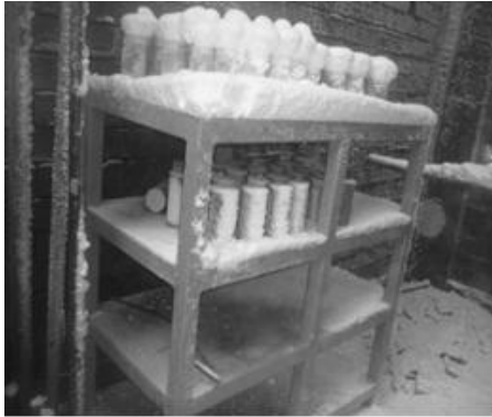
Figura 5. Probetas en exposición en ambiente industrial, cubiertas con cloruro de calcio.
