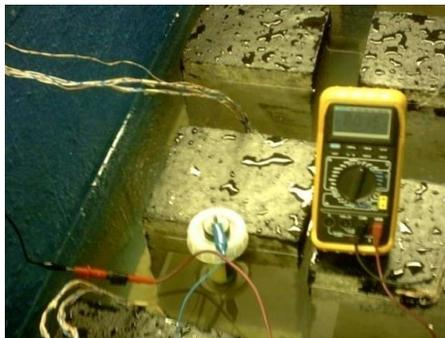
Figura 3. Monitoreo del sistema con multímetro y electrodo de referencia Cu/CuSO<sub>4</sub>
