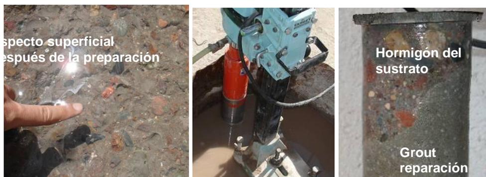
Figura 6. Preparación superficie del modelo y extracción de testigos.
