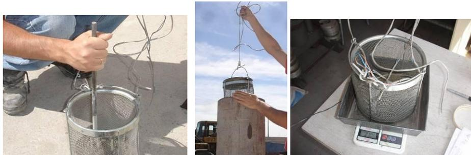
Figura 2. Fotografías del ensayo para la resistencia al lavado de mezclas según CRD-C 61-89A.
