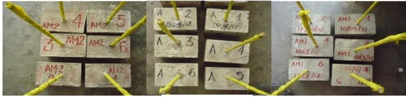
Figura 3. Cubos para revisión de adherencia
