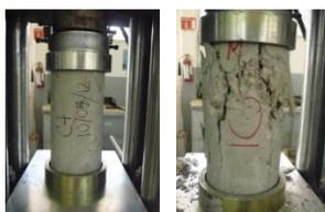
**Figura 2. Revisión de la resistencia a compresión de los cilindros de concreto**
