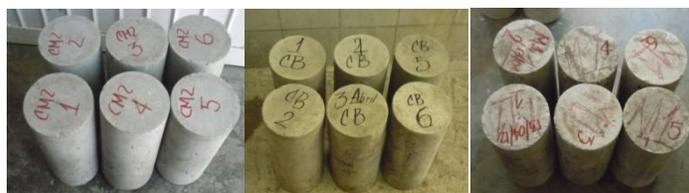
**Figura 1. Lotes de cilindros blanco y con contenido de carbonato de magnesio  $MgCO_3$**
