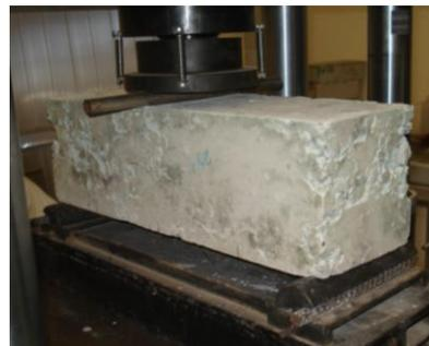
**Figura 2.** Configuración del ensayo de resistencia: a) compresión, b) flexión
