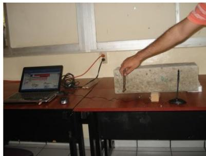
**Figura 4.** Configuración para determinar frecuencia de resonancia en el modo torsional.
