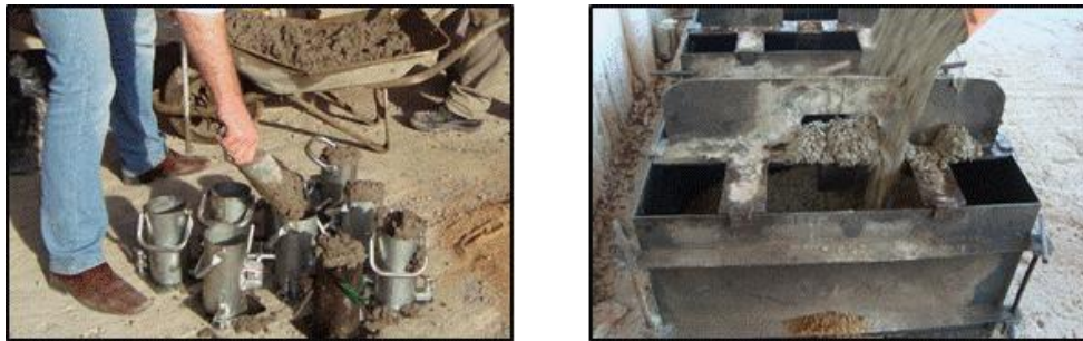
Figura 3 – moldagem dos corpos de prova e concretagem dos blocos de concreto após a incorporação do aditivo superplastificante, em cada tempo estudado
