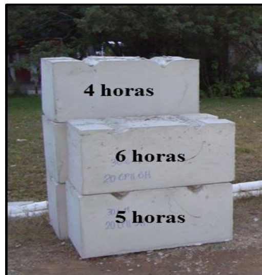
Figura 6 – acabamento obtido nos blocos de concreto
