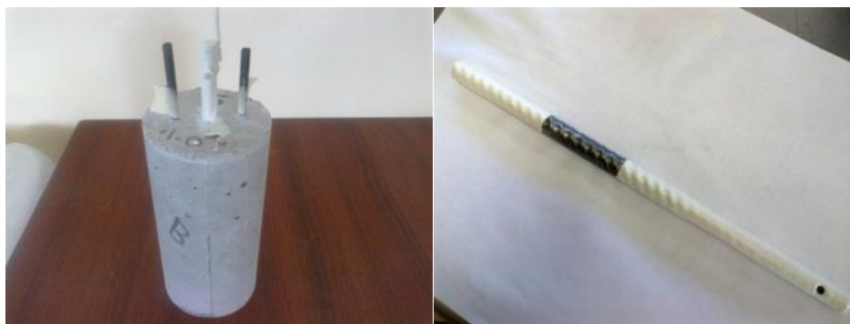
Figura 1. Espécimen con electrodo de grafito. Figura 2. Varilla recubierta con pintura epóxica.
