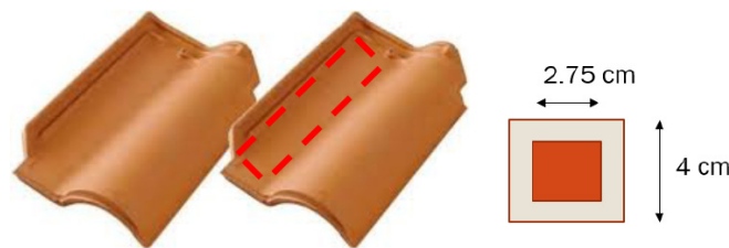
Figura 1. Obtención de los especímenes.
