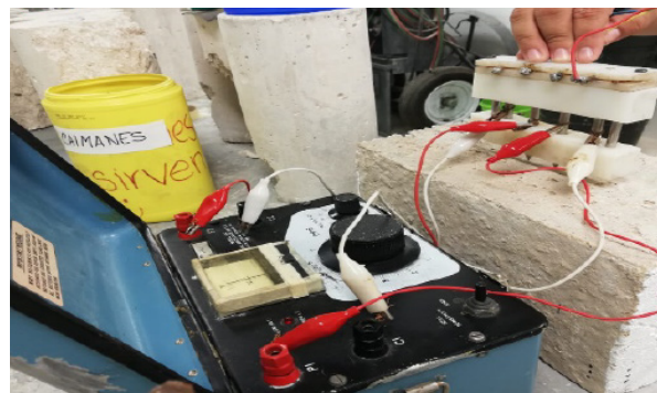
Figura 4. Medición de la resistividad.
