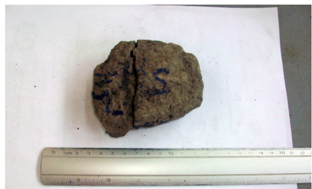
Figura 3. Muestra de roca ensayada en el aparato de carga puntual.
