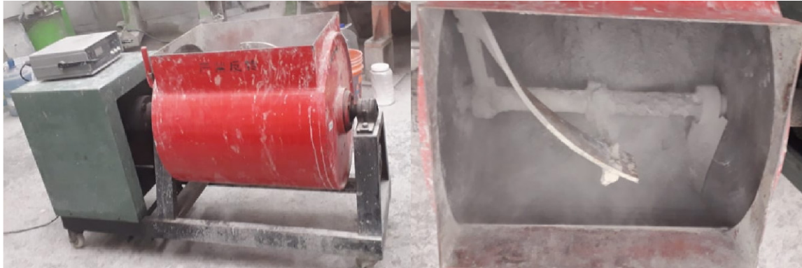
Figura 2. Mezcladora de eje horizontal utilizada para fabricar las mezclas.
