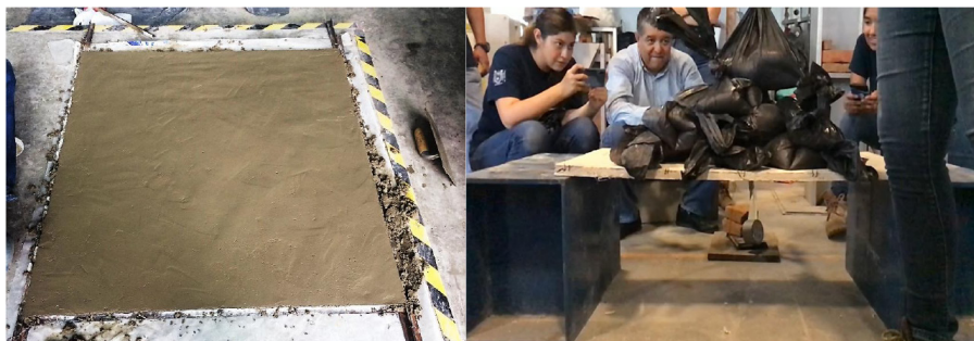
Figura 8. Elaboración de panel rectangular y su ensayo a carga y descarga (Elaboración propia).
