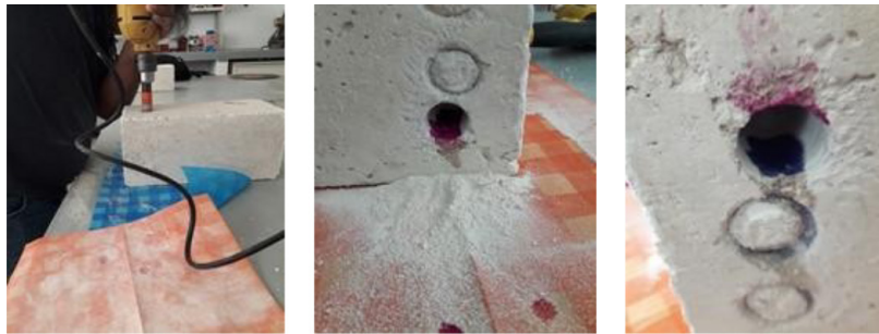
Figura 8. Extracción de cilindros y aplicación del método húmedo.
