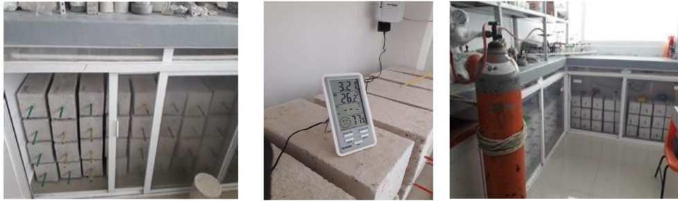
Figura 3. Estabilización de las cámaras de carbonatación.
