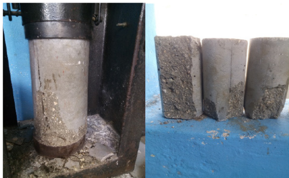
Figura 3. Ensayos de compresión.
