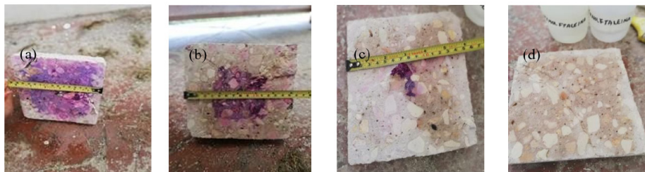
Figura 9. Resultados de la carbonatación, (a) primer corte; (b) segundo corte, (c) tercer corte, (d) cuarto corte.
