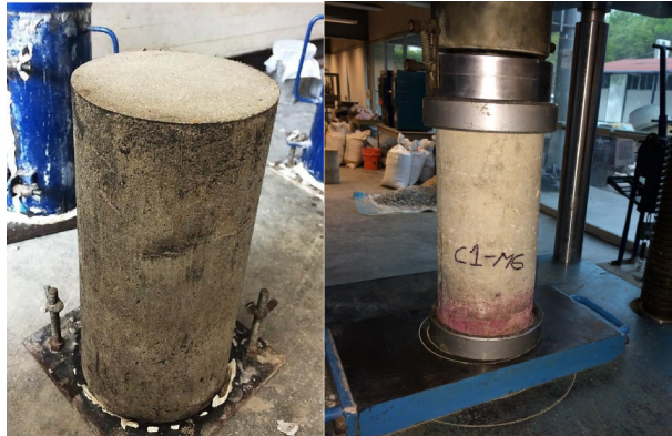
Figura 6. Elaboración de especímenes cilíndricos y su ensayo a compresión (Elaboración propia).
