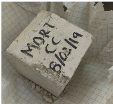
Figura 3. Mortero de cal de construcción.
