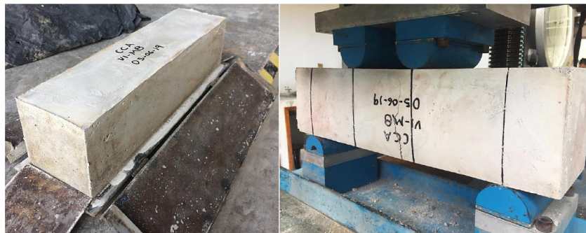
Figura 7. Elaboración de especímenes rectangulares y su ensayo a flexión (Elaboración propia).
