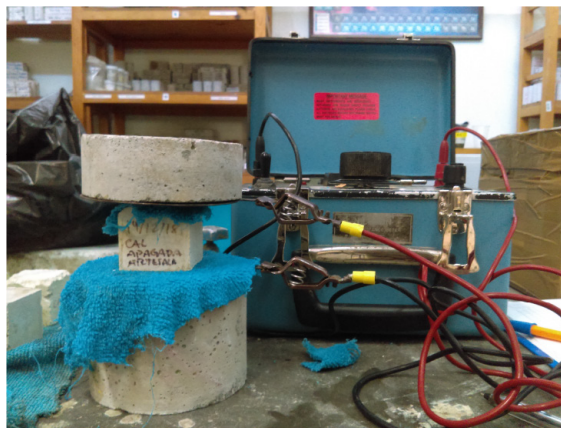
Figura 1. Prueba de resistividad eléctrica.
