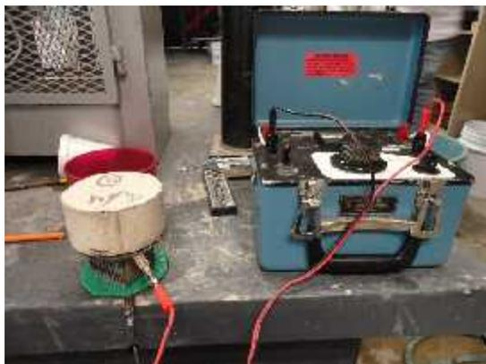
Figura 1: Prueba Resistividad Eléctrica a cubos (Fotografía L. Colín)
