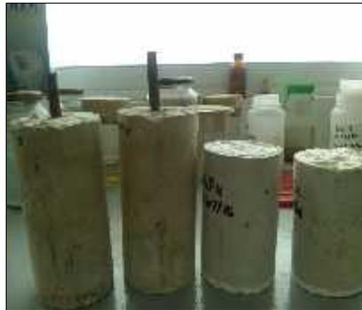
Figura 2. Cilindros de concreto simple y reforzado.
