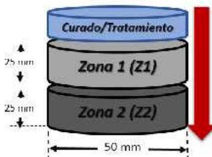
Figura 3. Obtención de secciones de las muestras de mortero para su evaluación.
