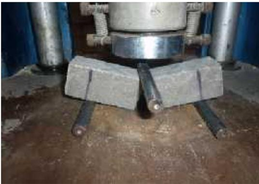
Ilustración 5 Espécimen colocado en la platina, para compresión simple. ASTM-C-109/2002.
