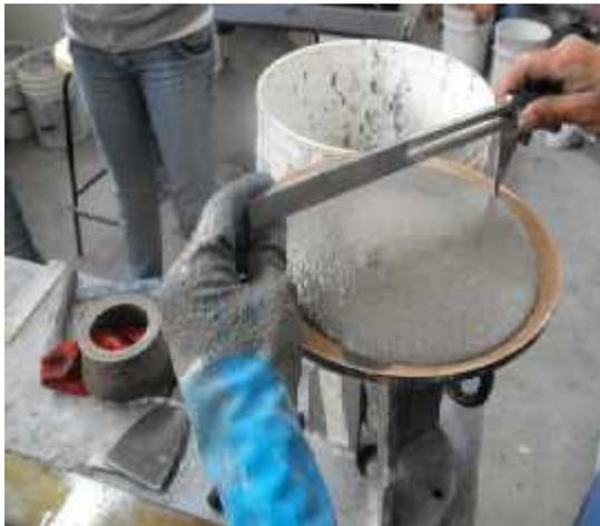
Ilustración 3 Prueba de fluidez
