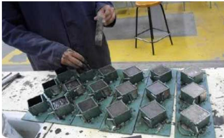
Figura 4. Elaboración de especímenes cúbicos de mortero.
