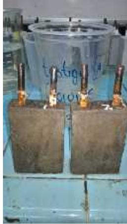
Figura 1: Probetas prismáticas para ensayos electroquímicos
