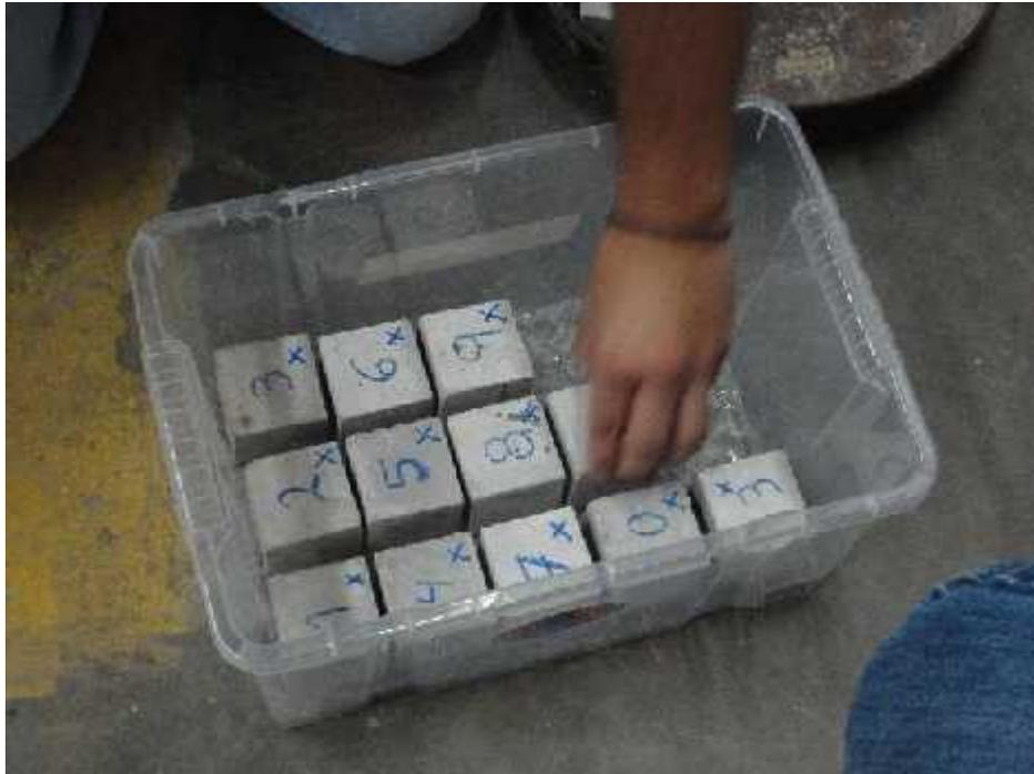
Figura 6. Prueba de Ataque por sulfatos a especímenes de mortero
