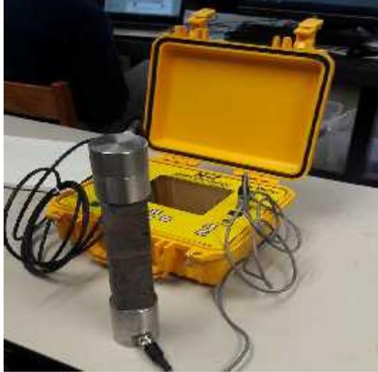
Figura 2: Velocidad de Pulso Ultrasónico (VPU) (Fotografía L. Colín)
