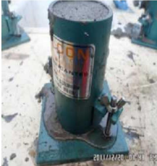
Figura 5. Elaboración de especímenes cilíndricos de mortero.
