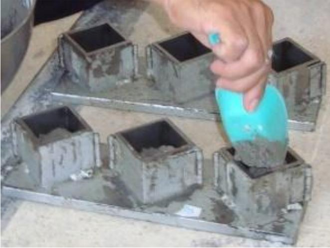
Figura 3.- Colado de cubos con mezclas de mortero
