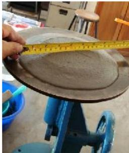
Figura 2.- Prueba de fluidez en mezclas de morteros
