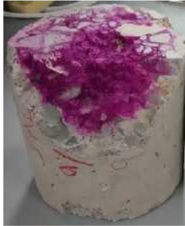
Figura 5. Cilindro 1 sin exposición dentro de la cámara (fenolftaleína).
