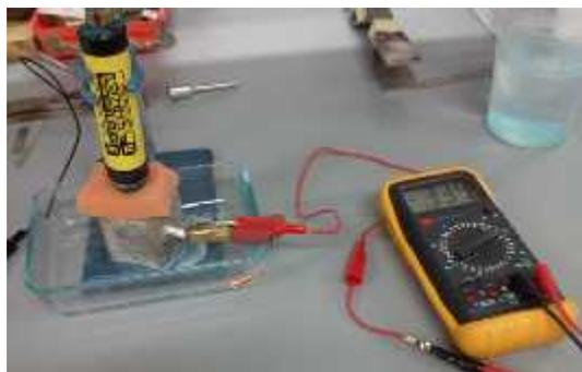
Figura 5. Medición de potenciales de corrosión en los especímenes de mortero.
