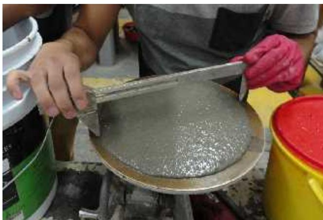
Figura 3. Prueba de fluidez realizada a una de las mezclas
