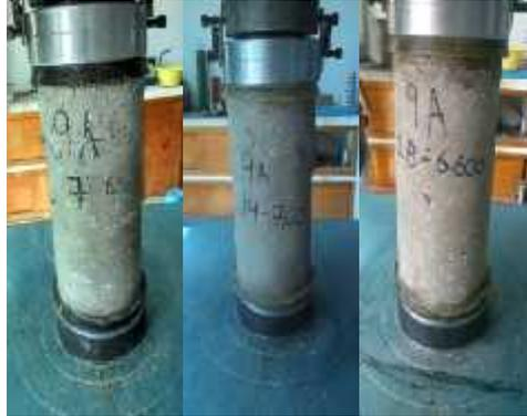
**Figura 4.** Cilindros de concreto Ligero ensayados a 7, 14 y 28 días
