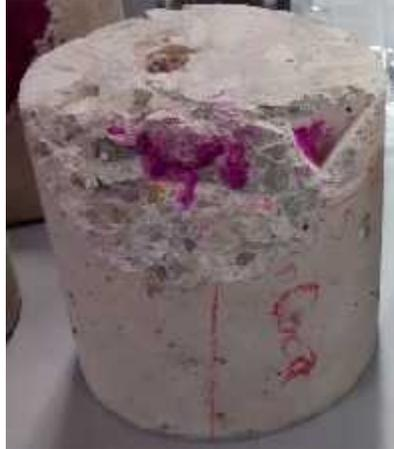
Figura 6. Cilindro 1 con exposición en la cámara (fenolftaleína).
