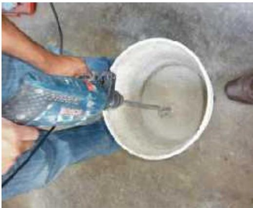
Ilustración 2 Método de mezclado mediante aspas de acero.
