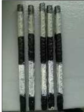
Figura 1. Aplicación del recubrimiento orgánico.
