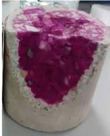
Figura 7. Cilindro 2 sin exposición en la cámara (fenolftaleína).
