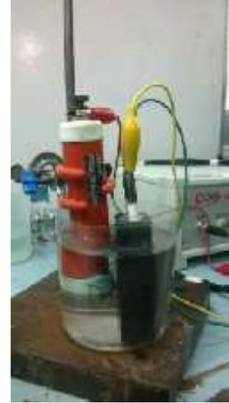
Figura 2: Celda de corrosión
