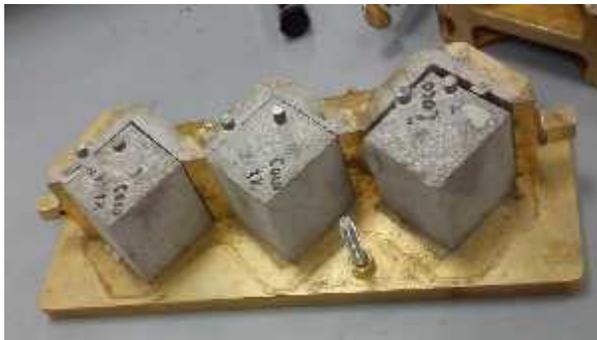
Figura 4. Desmoldeo de los especímenes de mortero con fibras de coco.
