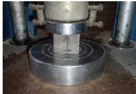
Ilustración 4 Espécimen marcado a una pulgada y en el centro del claro, para flexión. ASTM C 348-97, 2002.
