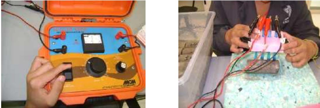
**Figura 3.** Equipo utilizado para la medición de resistencia y ejemplos de la medición.
