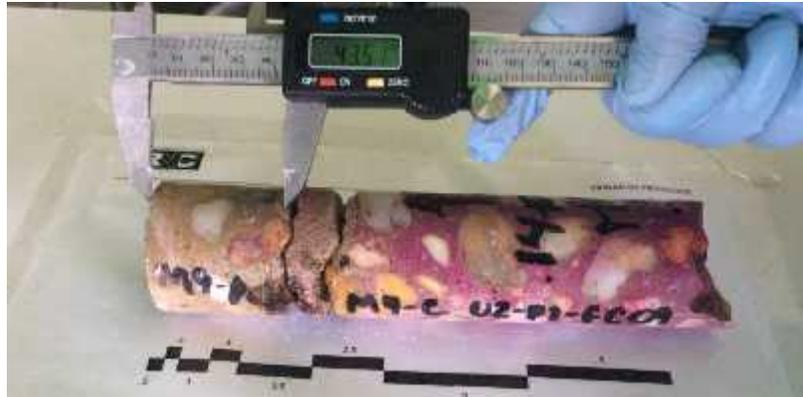
Figura 1. Profundidad de carbonatación en la zona U2-P1-P04, donde se observa una profundidad de daño considerable y grietas paralelas a la superficie.
