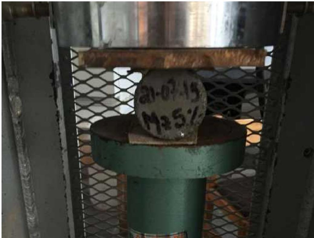
Figura 8. Prueba de Tensión indirecta
