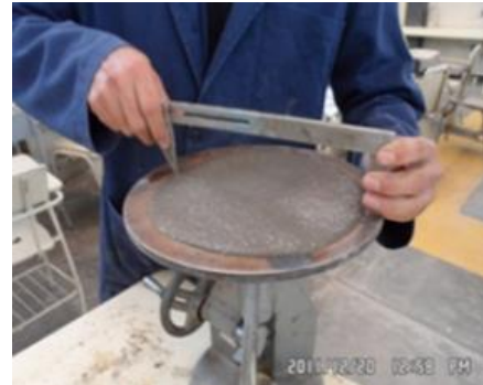
Figura 2. Realización de la prueba de fluidez al mortero. Fotografía de C. Bernabé.
