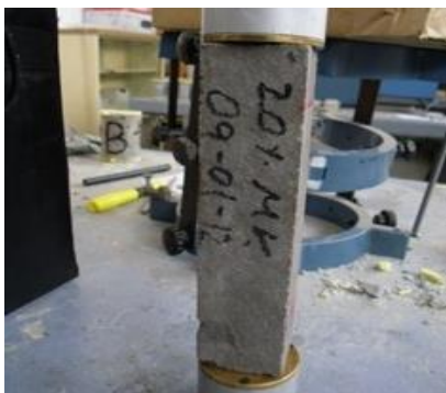
Figura 3. Prueba de velocidad de pulso ultrasónico en prismas de 4cmx4cmx16cm. Fotografía de C. Bernabé.
