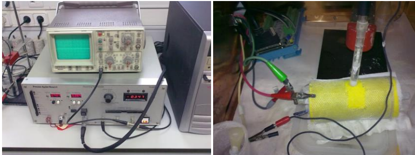
Figuras 5 (izquierda) y 6 (derecha). Imagen del potencióstato y la configuración de medición.
