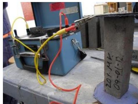
Figura 4. Prueba de resistencia eléctrica en prismas de 4cmx4cmx16cm. Fotografía de C. Bernabé.
