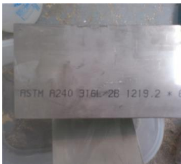
Figura 8. Placa de acero inoxidable AISI 316L, utilizada como contra electrodo. Fotografía de C. Bernabé.
