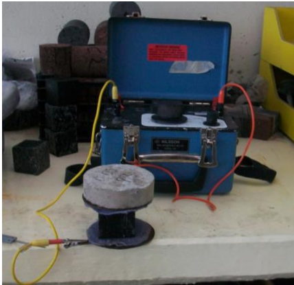
Figura 2. Equipo de resistividad (Fuente M. A. Navarrete Seras).
