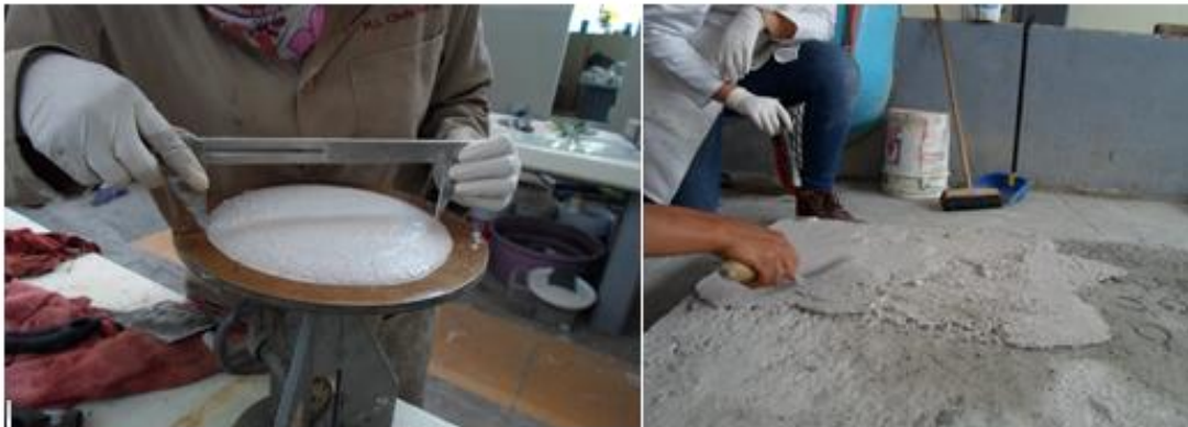
Figura 2. Prueba de fluidez y colado de losa
