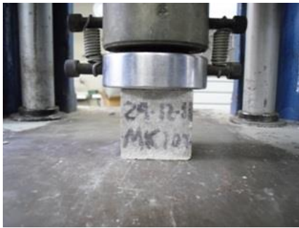
Figura 5 Aplicación de la carga en la prueba a compresión en cubos de 5cm.
