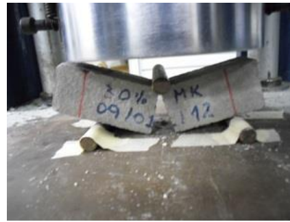
Figura 6 Realización de la prueba a flexión en prismas de 4cmx4cmx16cm. Fotografía de C. Bernabé.
