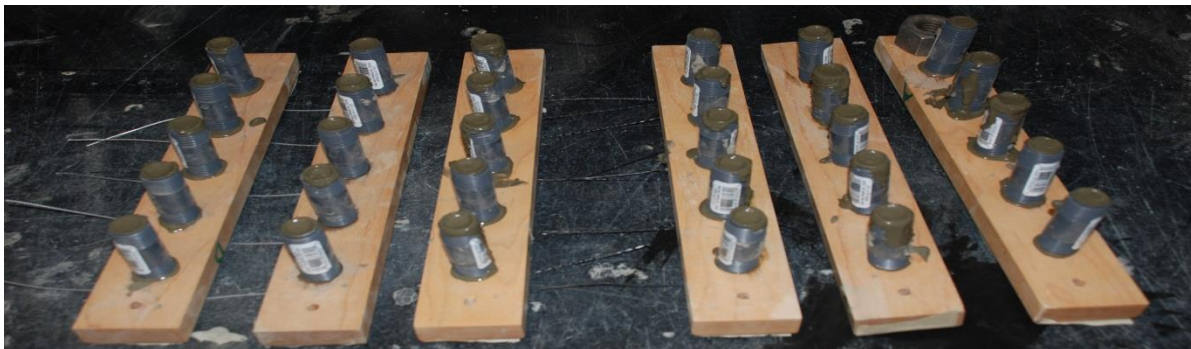
Ilustración 4. Moldes de madera de sujeción de la fibra y niples de 13mm x 50mm donde se vierte la matriz cementante
