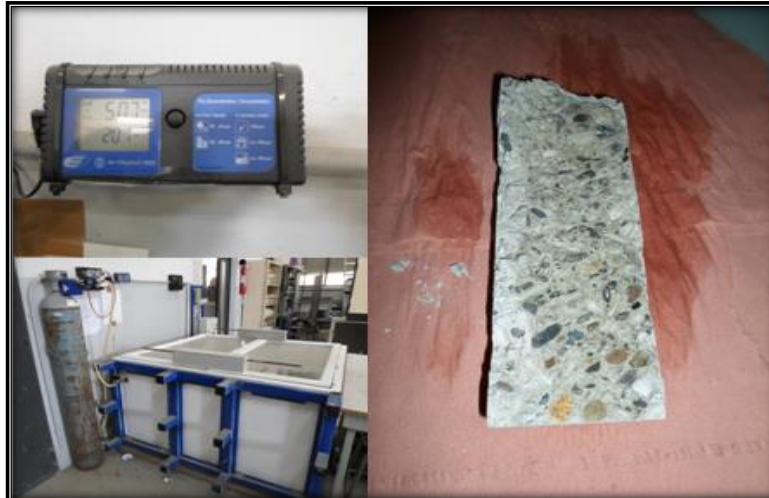
Fig. 3. Sistema de carbonatación y aspecto típico de un espécimen testigo totalmente carbonatado.
