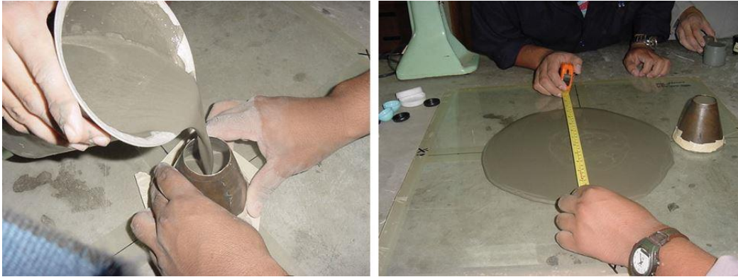
Figura 3. Prueba del mini-cono y medición de los diámetros d_1 y d_2
