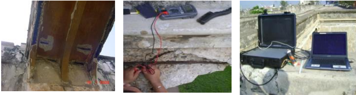
Figura 3. Puente Jesús Carranza. Lugar en donde se realizaron las medidas químicas y electroquímicas. Obtención de muestras M11 y M12.
