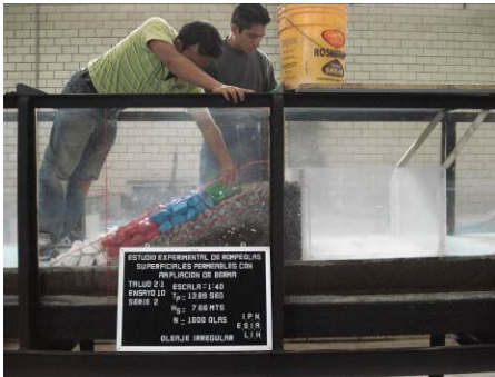
Figura 14. Colocación de las diferentes capas del rompeolas tipo.
