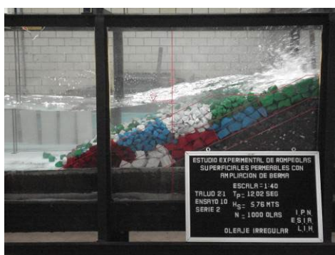
Figura 17. Ensayo 10. Primera berma con talud 2:1; T_p = 12.02 segundos y H_s = 5.76 metros. 10,000 olas acumuladas.
