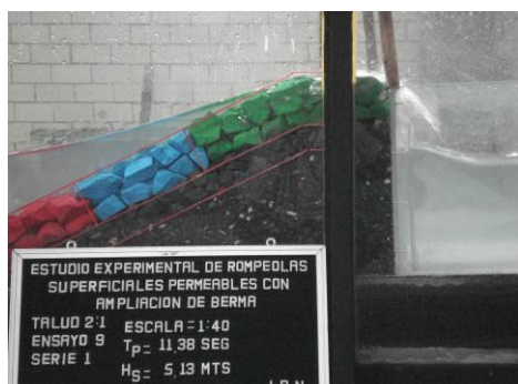
Figura 15. Rompeolas tipo (Estructura sin berma), talud 2:1, T_p = 11.38 segundos y H_s = 5.13 metros. 9000 olas acumuladas.
