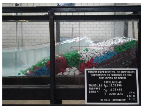
Figura 21. Ensayo 11. Tercera berma con talud 1.5:1, T_p = 12.02 segundos y H_s = 5.76 metros. 11,000 olas acumuladas.
