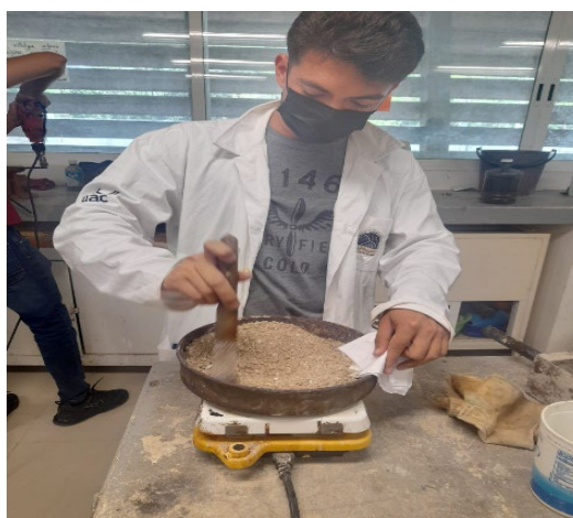
Figura 3. Obtención de contenido de agua de los agregados
