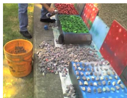
Figura 11. Rompimiento, clasificado y pintado de rocas de las diferentes capas del rompeolas.
