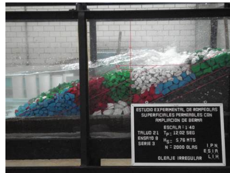
Figura 20. Ensayo 11. Segunda berma con talud 2:1, T_p = 12.02 segundos y H_s = 5.76 metros. 11,000 olas acumuladas.
