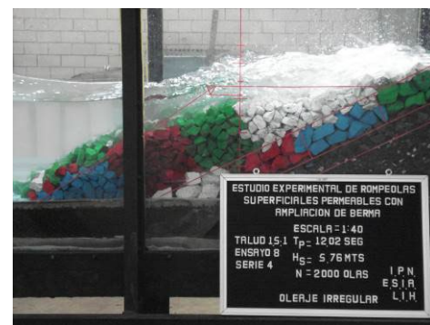
Figura 22. Ensayo 12 Tercera berma con talud 1.5:1, T_p = 12.02 segundos y H_s = 5.76 metros. 12,000 olas acumuladas.
