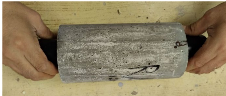
Figura 4. Medición de velocidad de pulso ultrasónico en el concreto
