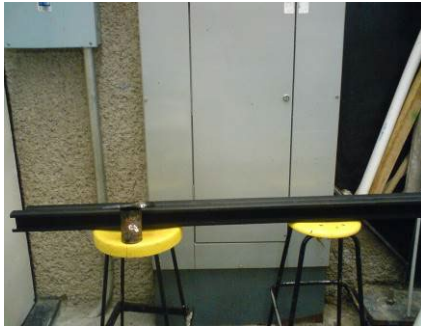
Figura 12. Perfilador de fondo manual para medir los niveles de las estructuras ensayadas.
