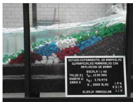
Figura 18. Ensayo 18. Primera berma con talud 2:1, T_p = 12.02 segundos y H_s = 5.76 metros. 11,000 olas acumuladas.
