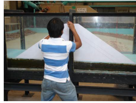
Figura 13. Colocado de los escantillones dentro del canal de oleaje angosto
