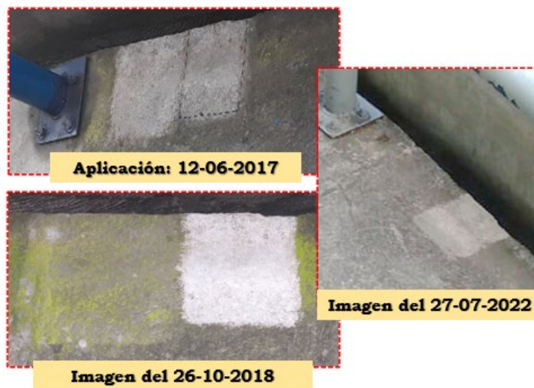
Figura 7. Fotografías de la evolución del T2 a una exposición en ambiente industrial/urbano.
