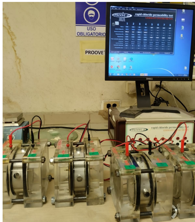
Figura 3. Medición de concentración de permeabilidad en el concreto.
