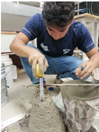
Figura 5. Prueba de revenimiento
