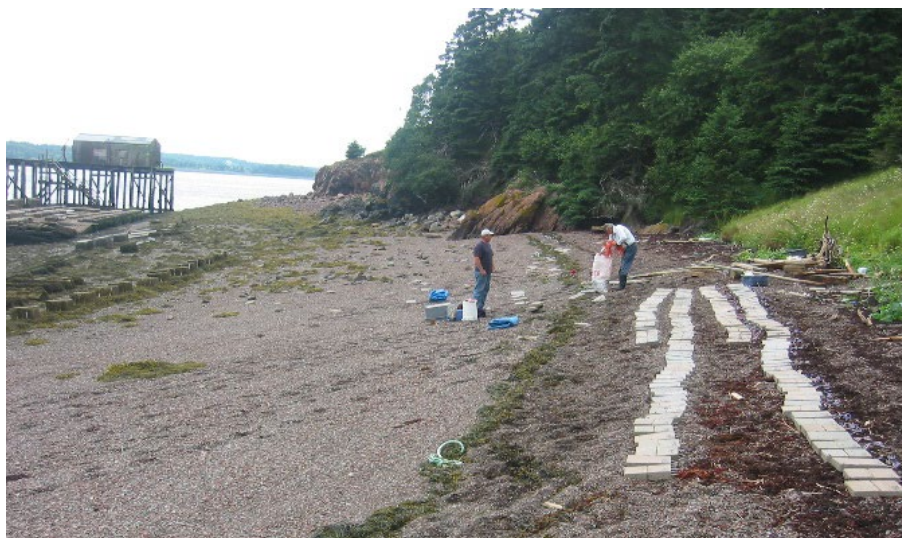
Figura 2. Exposición de los especímenes de concreto reforzado en el ambiente marino natural en la Bahía de Maine, EUA
