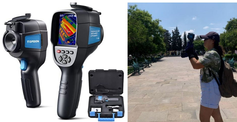
Figura 6. Ficha técnica de cámara térmica (Onset, 2018) y disposición de equipos en mediciones in situ
