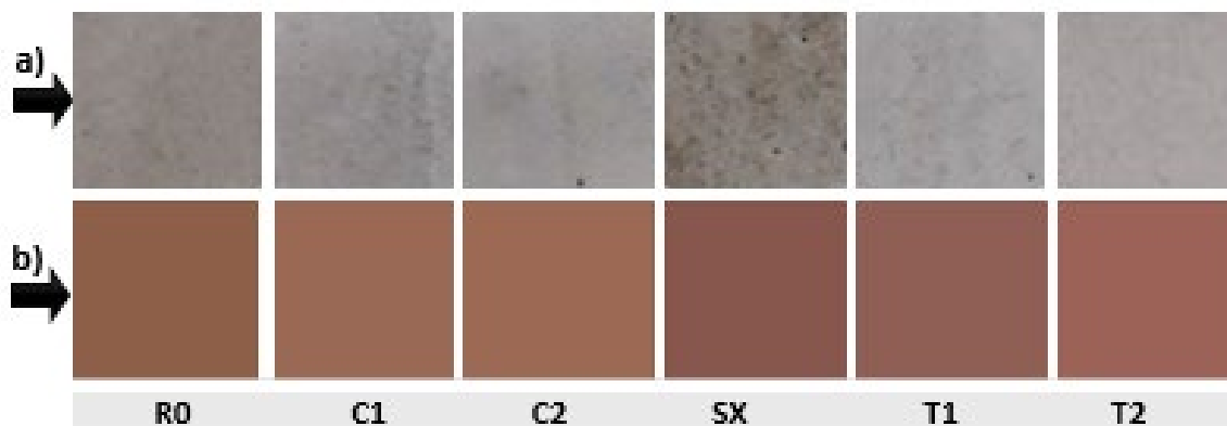
Figura 5. Colorimetrías obtenidas a 24 meses de exposición en ambiente industrial/urbano: a) morteros y b) tejas de arcilla.
