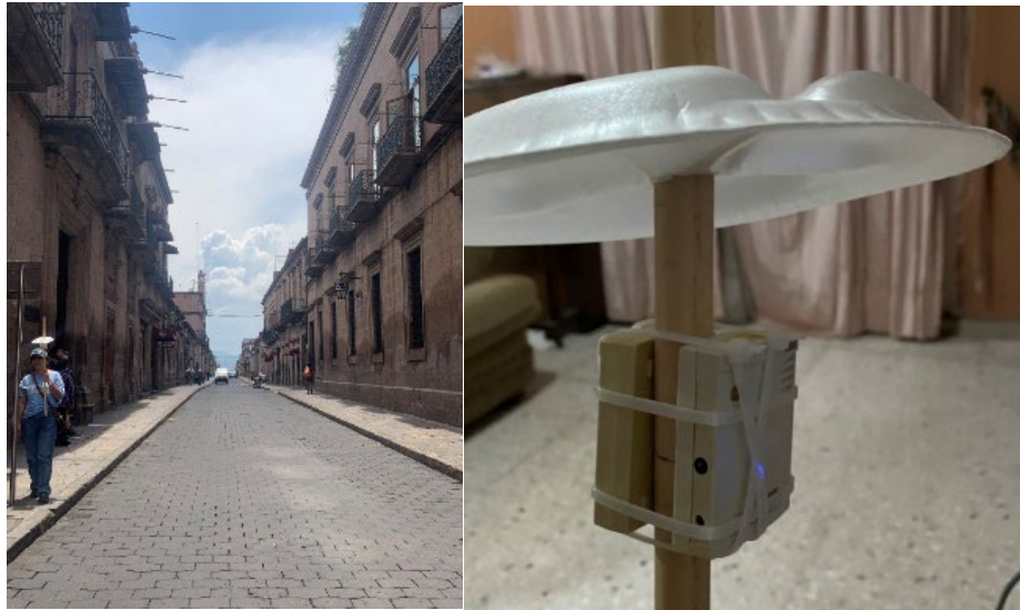
Figura 4. Imagen del cañón Vasco de Quiroga e Instrumentos de medición de temperatura cubierto para evitar la incidencia solar directa
