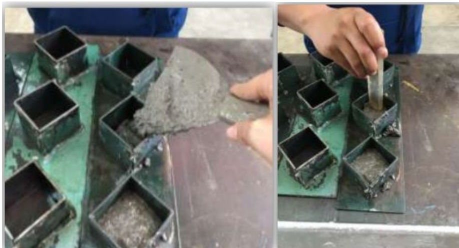
Figura 5. Elaboración de Especímenes de mortero base cemento portland
